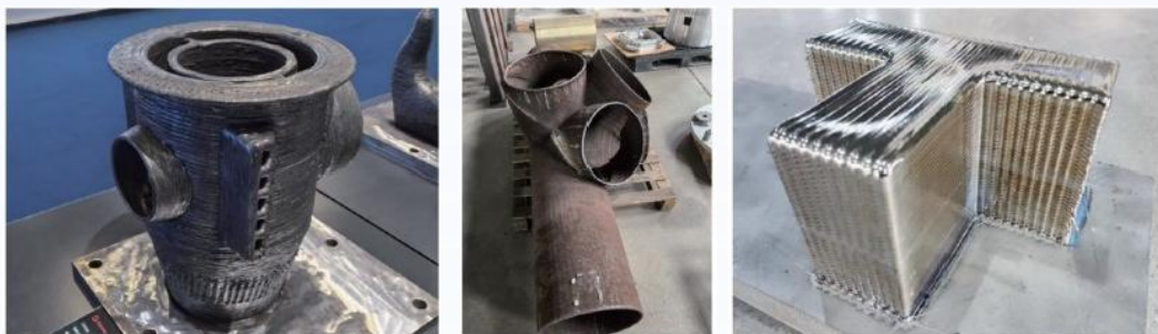
案例：电弧与激光打印制备多类型材料
