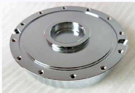
案例1: 工件表面的电沉积铬层
