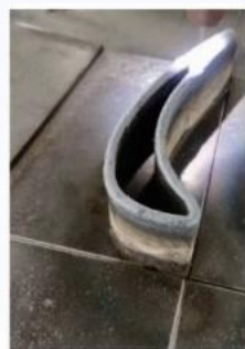
案例：等离子弧送粉打印叶轮材料
