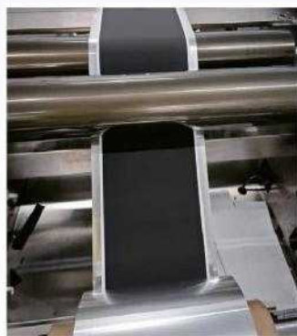
案例1 材料：电池正/ 负极极片的制 作
