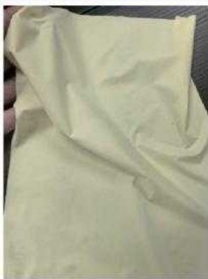
案例1 材料: PI 利用静电纺丝仪 制备纳米纤维防 水透气膜
