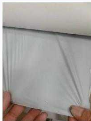
案例2 材料: PVDF 利用静电纺丝 仪制备纳米纤 维过滤膜
