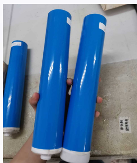
案例1 材料：反渗透膜 反渗透膜元件水/ 盐分离性能测试
