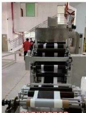
案例1 材料：电池正/ 负极极片的制 作
